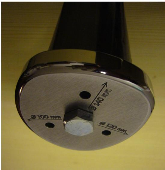
Mit der neuartigen Ausbeulscheibe können Sie entweder eine vor Ort vorhandene Stange mit max. 70 mm Durchmesser oder Ihre evtl. schon im Werkzeug vorhandenen dünneren zylindrischen Pfeifenformen bis Durchmesser 70 mm mit kürzerer Länge so kombinieren, daß Sie die nötige Gesamtlänge für die großen langen Pfeifenkörper erreichen.
