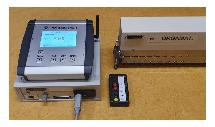
Steuergerät: Spannungsversorgung 230V (oder 115V)
