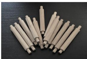
Die zylindrische Form und die zwei Zapfenlängen, 12 bzw. 15 mm, lassen alternative Einbauvarianten zu. Distanz nach Einbau 125 mm. Zapfendurchmesser 12 mm.
